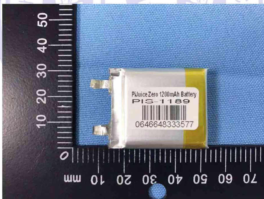
Photo 4 Internal Cell 内部电芯
